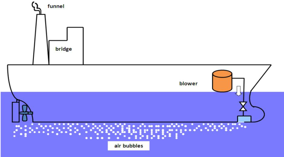
**Hull Air Lubrication**
